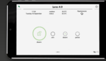
ERGO-T 7" touch display 01865 PoE interface en 12Vdc
